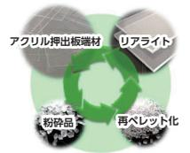
回収→粉砕→再原料化という簡略化された製造工程のため、一般バージン品と比較しペレット製造時のCO<sub>2</sub>排出量が71%削減できます。プロジェクターレンズ、メーターカバー等のハイスpekクなアクリル成形品をリサイクルしているため、透明性など一般的な新生アクリル板と同等の物性を有します。（全光線透過率92%、ヘイズ0.5%）グリーン購入適合商品、エコマーク認定商品の開発に適性のある商品です。
